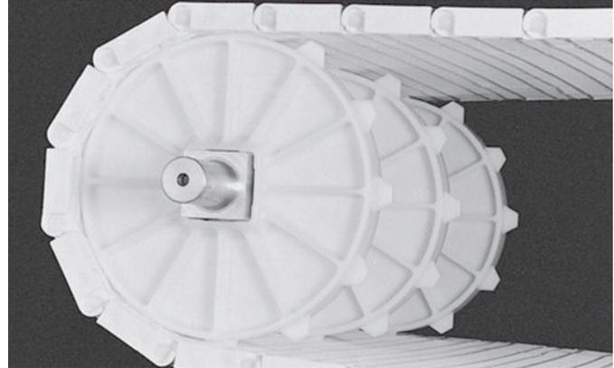
**Abbildung 4:** Zahnräder mit Vierkantbohrung auf Vierkantwelle
